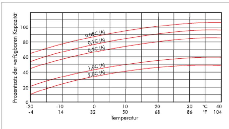
Temperatureinfluss auf die Batteriekapazität
