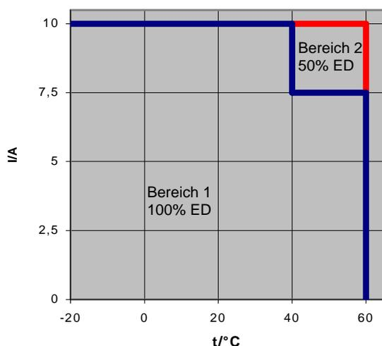
Für die Betrachtung der Einschaltdauer sind nur die Lade- und Entladezyklen der Kondensatoren relevant. Ist das Puffermodul aufgeladen und arbeitet im Standbymodus tritt keine Erwärmung des Gerätes auf. Dieser Fall ist somit thermisch mit einem ausgeschalteten Gerät gleichzusetzen.
