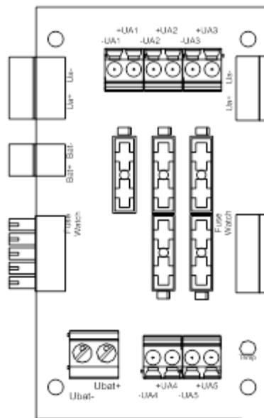
**Anmerkung:** Mit der neuen Generation der Sicherungsplatten (NBP21249G10001) gibt es nur noch einen Typ. Zur Erweiterung wird wiederum eine Sicherungsplatine des gleichen Typs verwendet.
