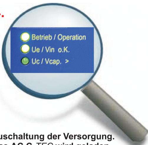
Zuschaltung der Versorgung. Das AC C-TEC wird geladen. Die LEDs „Betrieb/Operation“ und „U<sub>e</sub>/V<sub>in</sub> o.K.“ leuchten
