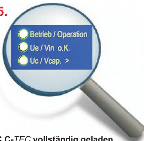
AC C-TEC vollständig geladen. Die LEDs „Betrieb/Operation“, „U<sub>e</sub>/V<sub>in</sub> o.K.“ und „U<sub>c</sub>/V<sub>cap</sub> >“ leuchten
