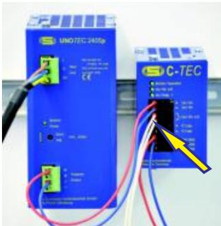
Verdrahtung des Meldekontaktes. Eingangsspannung OK
