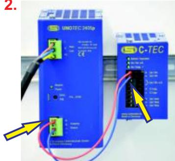
Anschluss des C-TEC an den Ausgang des 24 V DC Netzgerätes
