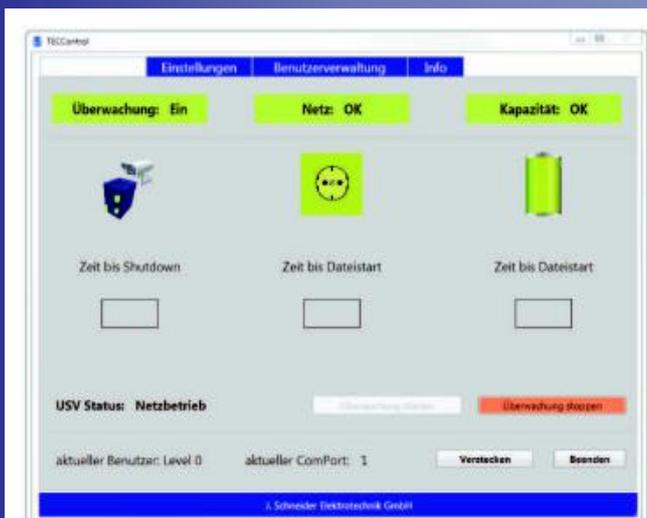
Die TECCentral Software automatisiert den System-Shutdown bei Netzausfall und den kontrollierten System-Neustart bei Netzwiederkehr. Unkontrollierte Prozessstops werden vermieden.
