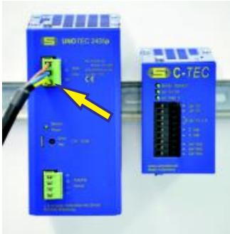
Anschluss des 24 V DC Netzgerätes an das Versorgungsnetz (230 V AC)
