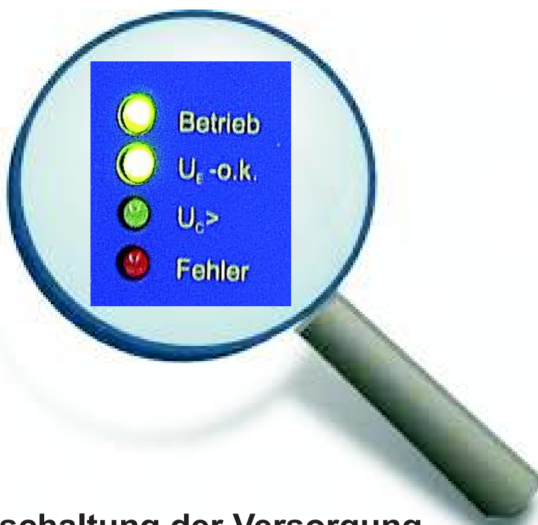
Zuschaltung der Versorgung. Das C-TEC wird geladen. Die LEDs „Betrieb“ und „U E ok“ leuchten
