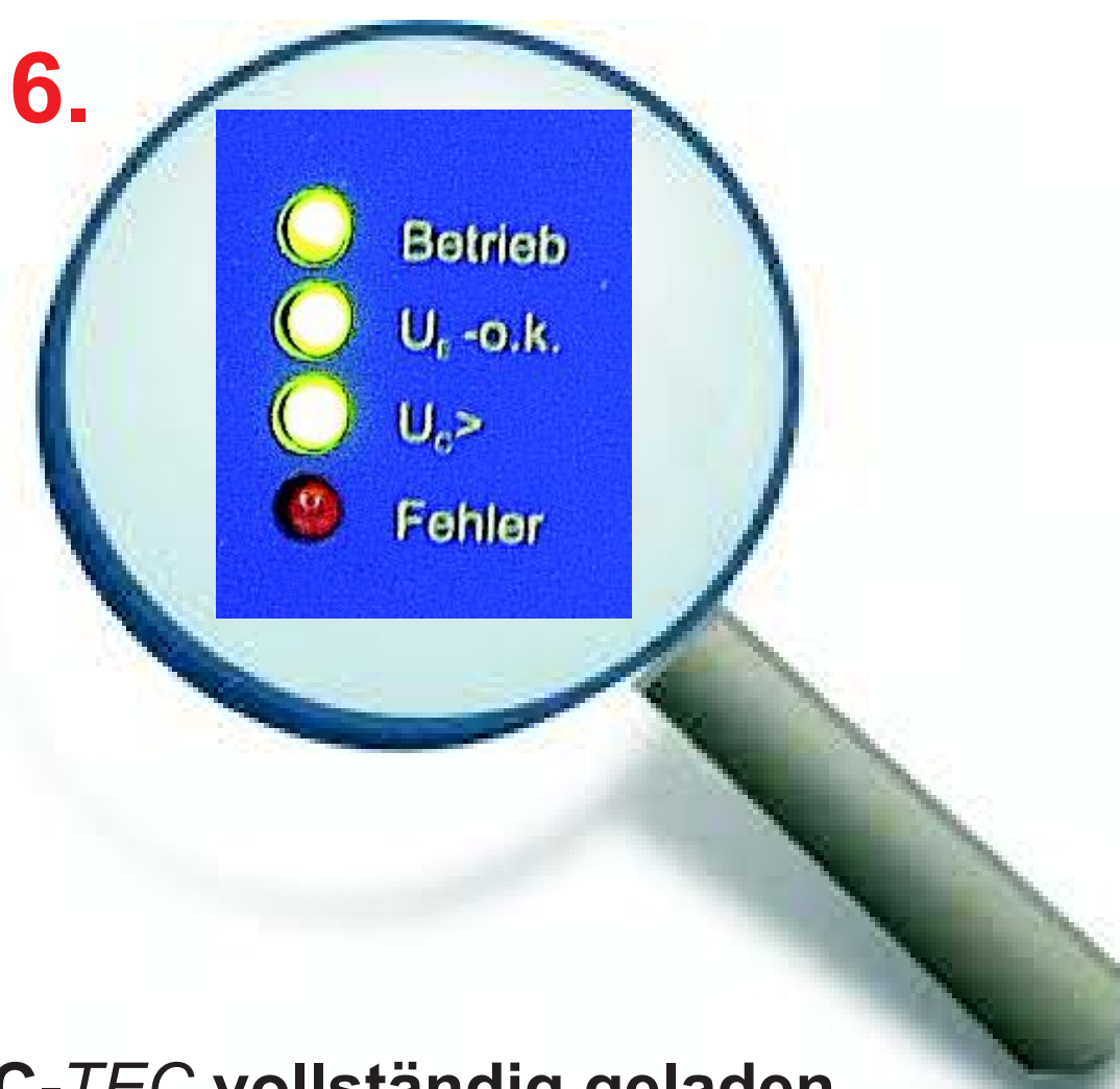
C-TEC vollständig geladen. Die LEDs „Betrieb“, „U E ok“ und „U C >“ leuchten
