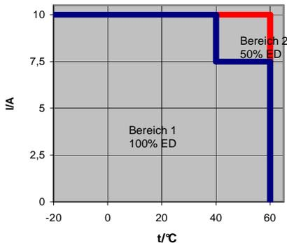
Einschaltdauer in Abhängigkeit des Laststromes und der Umgebungstemperatur
